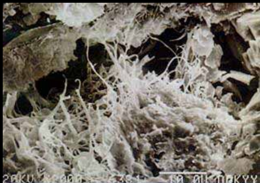
纤维状伊利石 细粒砂岩 粒间孔隙、喉道内纤维、发丝状伊利石丛生、搭桥、影响喉道。SEM, \times 2000 。
