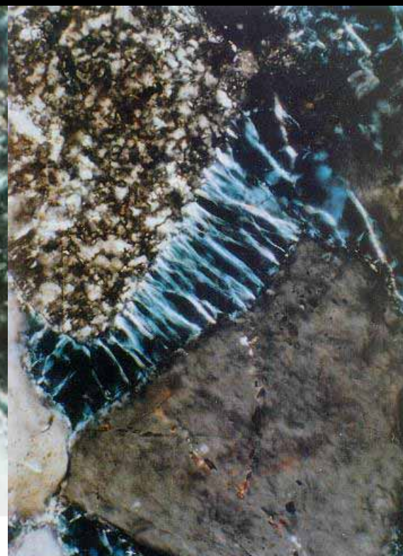
丝状伊利石搭桥 细粒砂岩 孔隙、喉道内伊利石搭桥。正交偏光， \times 700 。 白垩系，大庆油田宋3井1284.7m。
