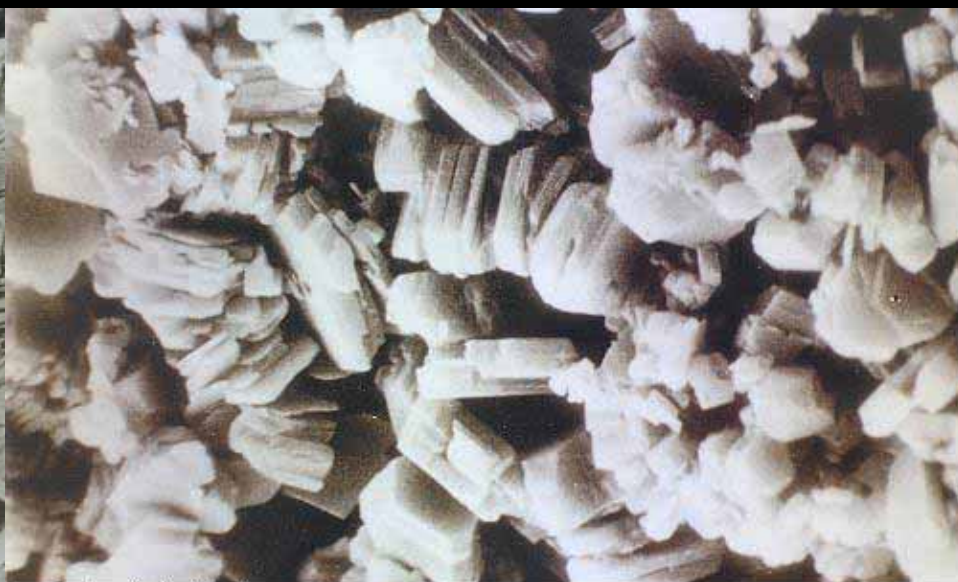
自生高岭石 粗-中粒石英砂岩 自生高岭石晶体。 SEM, ×3600。 侏罗系三间房组, 吐鲁番-哈密盆地温 1井2807.0m。
