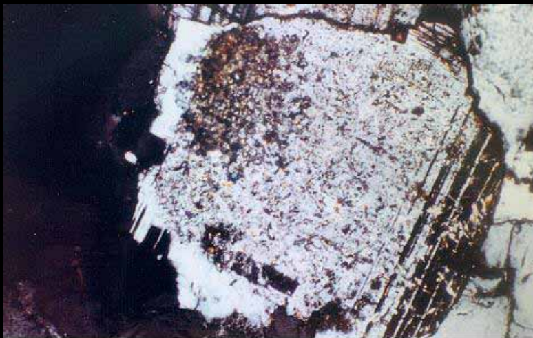
长石加大 中-粗粒长石岩屑砂岩 长石次生加大。正交偏光， \times 300 。 白垩系梨树组，吉林油田梨参2井1992.0~1995.0m。
