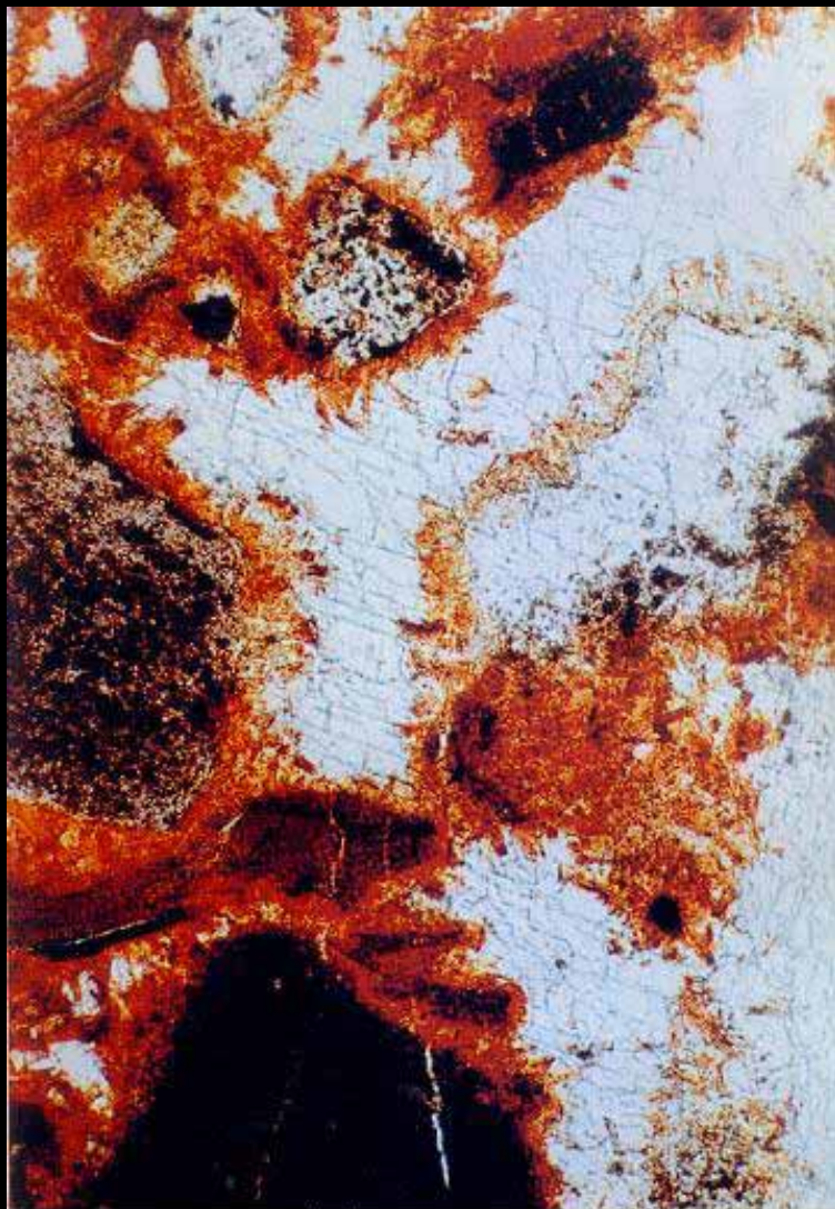
浊沸石胶结 砾石 片沸石后又充填浊沸石。 单偏光, \times 80 。 二叠系, 克拉玛依油田百鸟7井 2683.6m。
