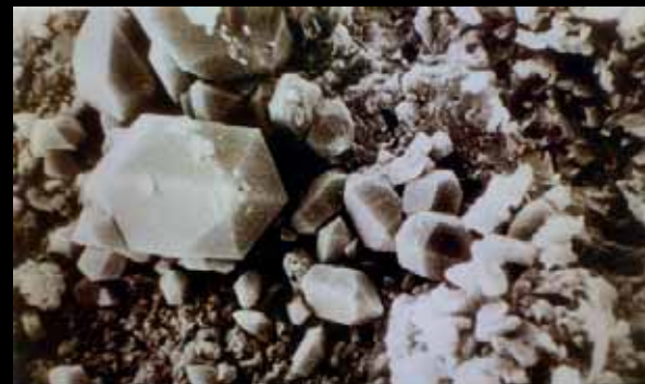
自生石英晶体 粗-中粒岩屑砂岩 自生石英晶完好。 SEM，×2700。 侏罗系三间房组，吐鲁番-哈密盆地温1井2486.7m。
