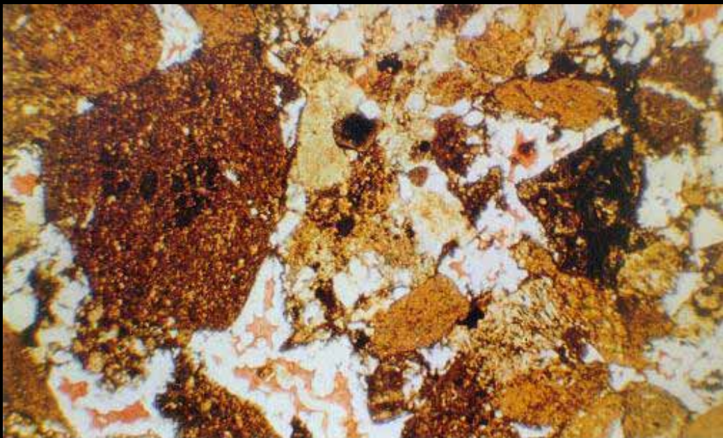
方沸石胶结 砂砾岩 方沸石胶结物。中间为残留孔隙。红色 铸体，单偏光， \times 75 。 二叠系，克拉玛依油田817井 3011.6m。
