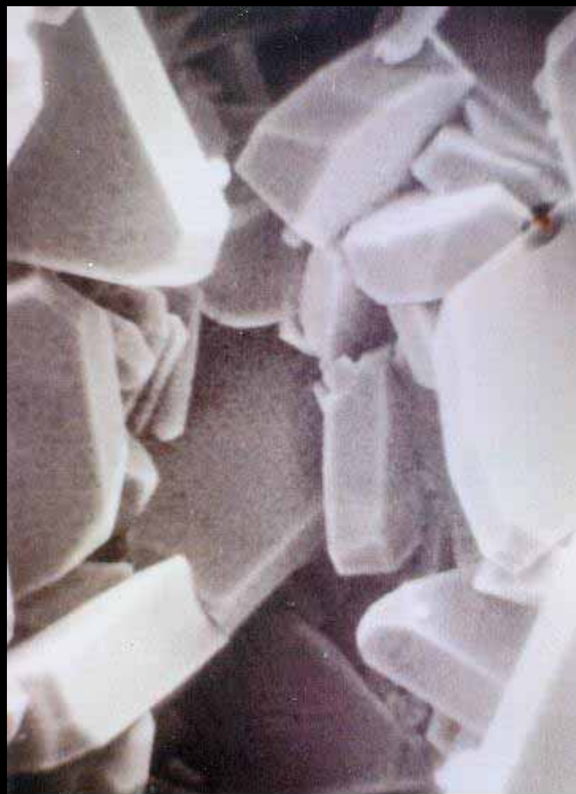
片沸石特征 砾岩 片沸石。SEM, \times 3700 。 二叠系, 克拉玛依油田百鸟7井 2666.0m。
