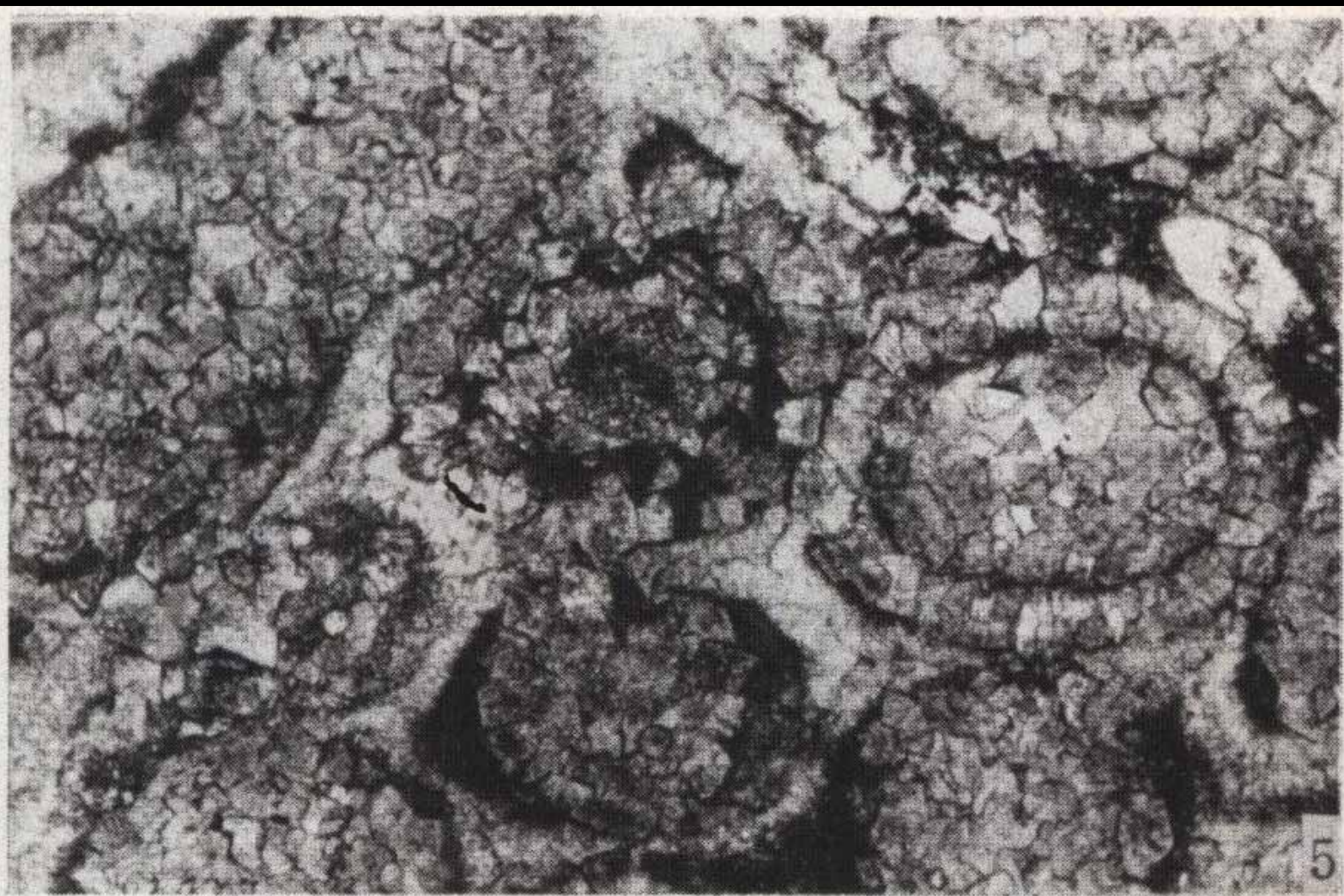
5. 残余鲕粒白云岩。鲕粒大部分已被白云化，仅显示鲕粒轮廓；白云石呈菱形，较污浊。亮晶方解石胶结。蒲圻观音山，单偏光， \times 33 。
